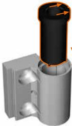
Lagerbuchse einschieben, Markierungspfeile zeigen in Richtung des Flügels.
